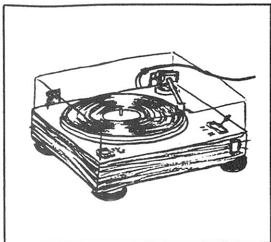
Spåren ger vibrationer, som via magnetism blir till spänningar...
