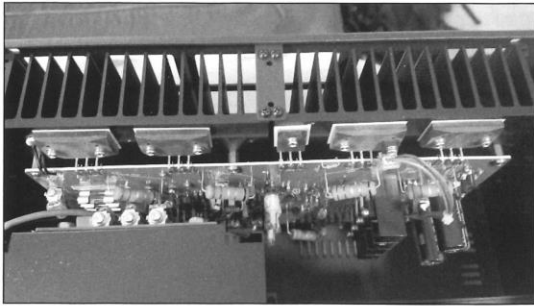
Ena förstärkarkanalerna. Det ser snyggt och prydligt ut. Kylflänsen har stor kylyta eftersom den är så hög. Förstärkaren blir inte särskilt varm utanpå.
