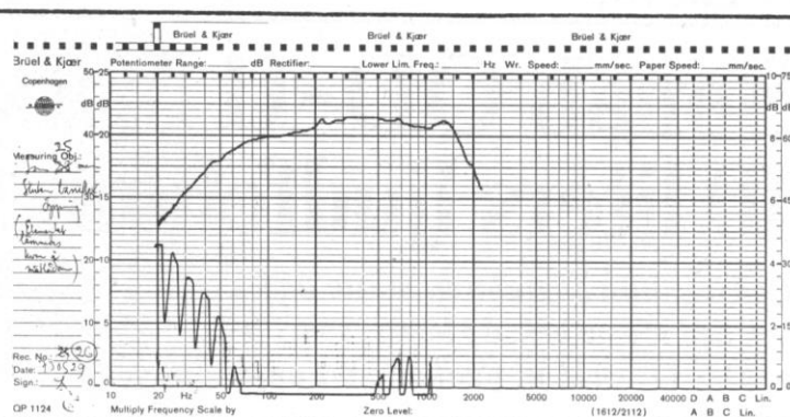
Fig 5. Mätning snarlikt den i fig 4. Samma betingelser, dvs som kurvorna är lagda bör nivån ökas med 10 dB för att korrekt markera differensen mellan distorsions- och signaltagning. Frekvensgången för elementet börjar falla av över 40 Hz, varvid distorsionen ligger 35 dB under signalen vid en spänning (6 V) som är något mindre än den som nominellt krävs för driveffekten. Det gör en distorsionsgrad om 1,8 % vid fullt ut bibehållen nivå och frekvensen 40 Hz. Sluter man till basreflexöppningen sjunker kurvan vid 40 Hz drygt 7 dB samtidigt som distorsionen stiger till 3,5 %. — Lyfter man 7 dB på tonkurvan så kommer den i originalregistreringen gröna tonen — som är ointressant — att stiga 14 dB, den röda med 21 dB. Skillnaden, 14 dB, skall dras från 29 dB och vi får då 15 dB, vilket motsvarar en distorsion om 18 % i stället för de ursprungliga 1,8 procenten. Slutsatsen är alltså att vid en viss ljudnivå uppstår 10 ggr högre distorsion vid en sluten låda än vid en basreflexlösning.
