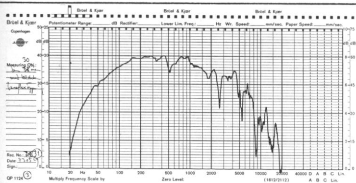
Fig 3 a) Ur ett stort material av studier över högtalarens tillblivelse och konstruktiva förstadier kan RT återge några registreringar ur Stig Carlssons dokumentation. Här är en prototyp till OD-11 där basreflexöppningen tillsluts. Som synes uppträder ett brant fall i frekvensgången från ca 200 Hz. b) Samma betingelser och med distorsion registrerad.
