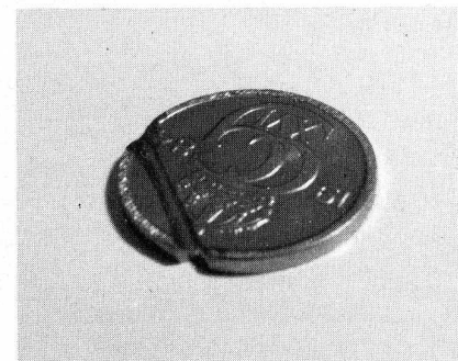
3. Slipa ett spår i baksidan där jordtråden kan lödas fast...
