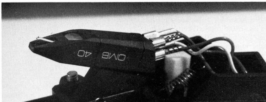
VTA-fjäders resonans dämpas elegant med en bit radergummi.
