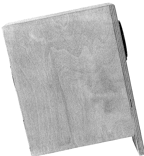
Da man am Computer relativ nah an den Lautsprechern sitzt, ist eine Neigung nach hinten sinnvoll. Beim CT227 erledigt das die überstehende Schallwand, was komplizierte Winkelschnitte vermeidet
