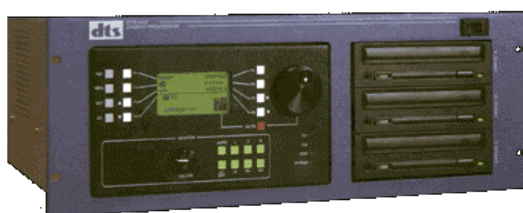
Figur 6: En avkodare för DTS, med CD-slädarna till höger.
