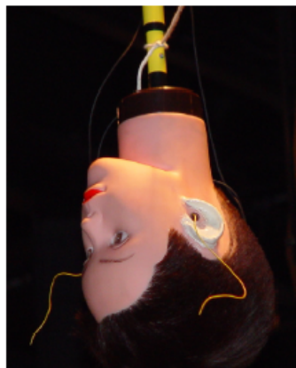
Figur 8-8: Binaurala mikrofoner monterad på ett dockhuvud [xiv]
