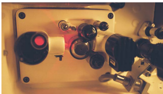
Figur 3: Philips makro-tonhuvud "Symfoni" här i DP70 projektorns inbyggda variant. Ombyggd till röd LED istället för vanlig tonlampa. Riviera (SF), Stockholm feb 2001. Bild och text Martin Voss-Shrader
