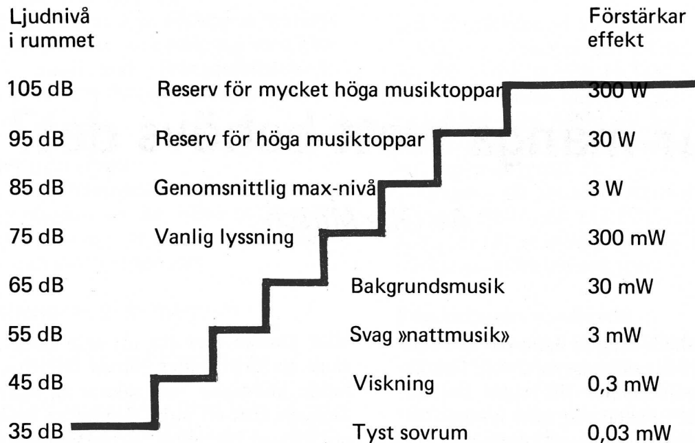
Fig. 1. »Ljudnivåtrappan». Visar sambandet mellan ljudnivån i rummet och den förstärkarut effekt som behövs i en genomsnitts-ljudanläggning för att åstadkomma denna ljudnivå.
