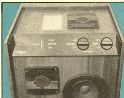
OM 71 har både överstyrningsindikatorer och nivåkontroller.
